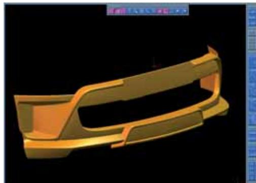
Das gefilterte und beschnittene Netz des vorderen Stoßfängers. So sieht das Anbauteil aus.
